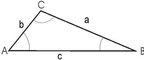
Los ángulos de un triángulo se representan con letras mayúsculas (A,B,C) o bien con letras griegas, ( $\alpha$ ,  $\beta$ ,  $\xi$ ,  $\delta$ ...). Como ves en el dibujo, los lados de un triángulo se nombran teniendo cada uno a su ángulo correspondiente en posición opuesta.
