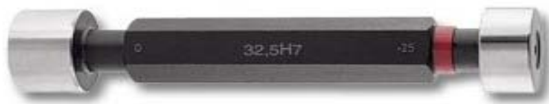
si pasa el lado con el anillo rojo el agujero tiene sobre medida y estaría mal
